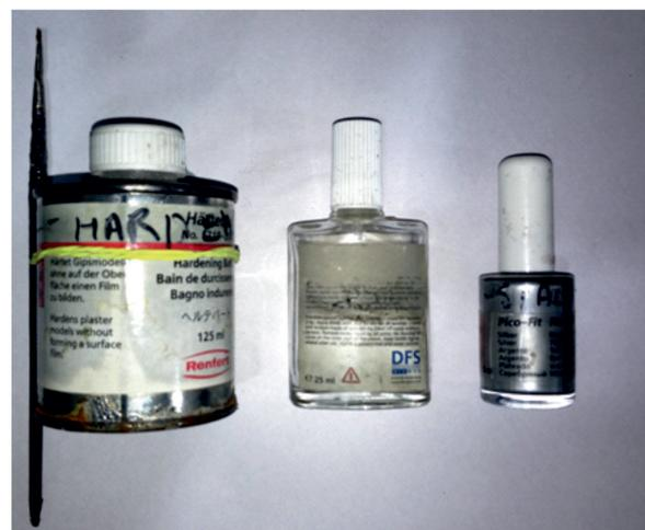
**Fig. 21.15:** Die spacer and die hardener
